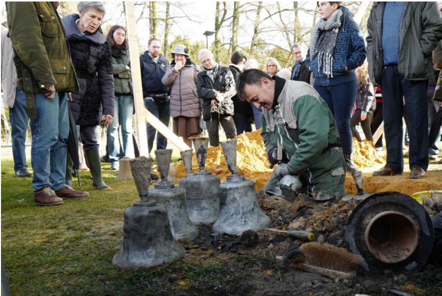
Démoulage de quelques cloches – 11 novembre 2018
